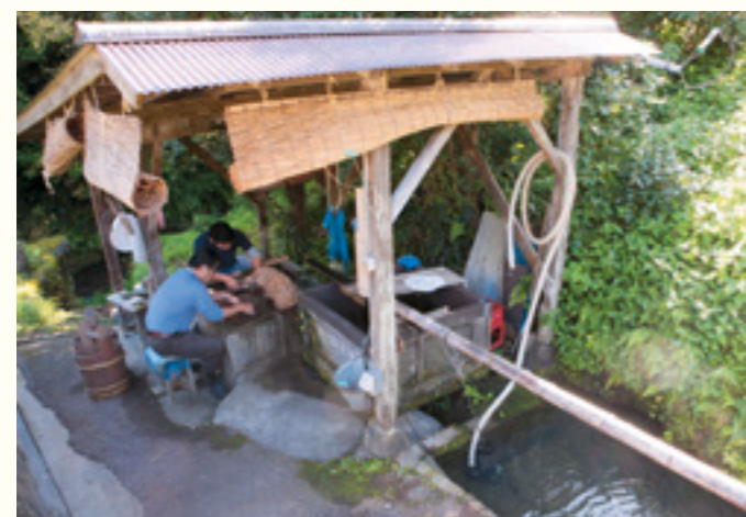
“除尘”利用流水去除残留杂质的作业
