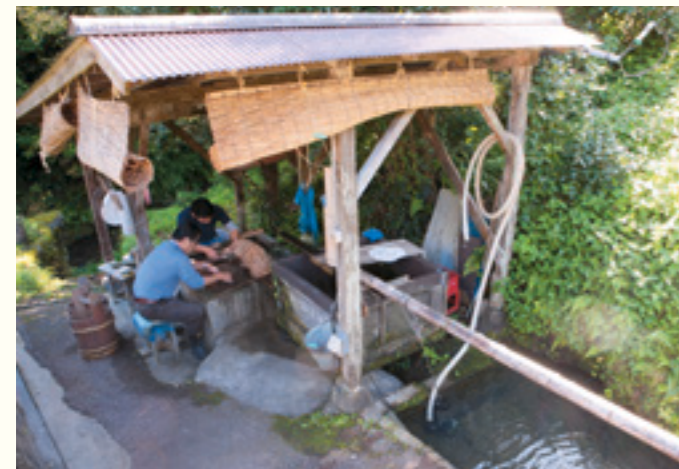
Étape "Chiriyori" pour retirer les impuretés restantes à l'eau courante
