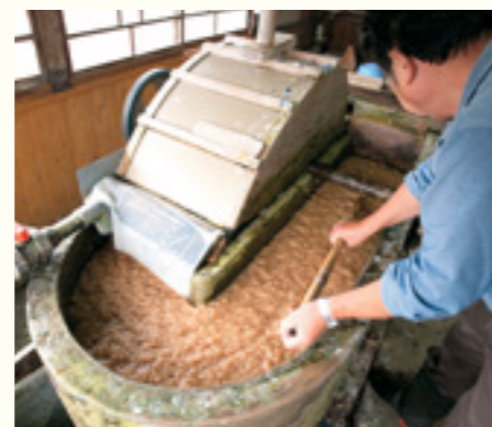
On détend les fibres avec le beater
